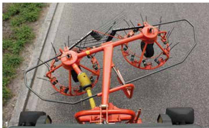
1. Posição de transporte da HAYBOB 300 - 2. Posição de transporte HAYBOB 360
