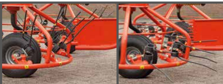
Garfos controlados por força centrífuga
