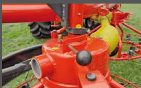
Alavanca para inversão da rotação da rotor e adesivo para instruções (Haybob 360)
