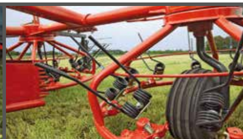
Pneus estriados resistentes à perfuração
