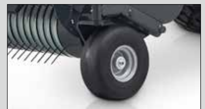
Rodas guias giratórias semipneumáticas de poliuretano
