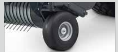
Rodas guias giratórias semipneumáticas de poliuretano
