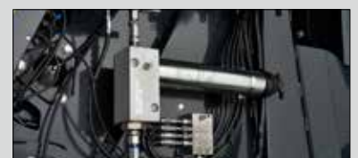
Sistema automático de lubrificação para rolamentos de rolos
