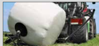
Tombador de fardos, descarregando o fardo em sua extremidade plana
