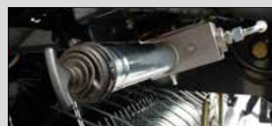
Sistema BEKA-MAX de lubrificação automática de rolamentos
