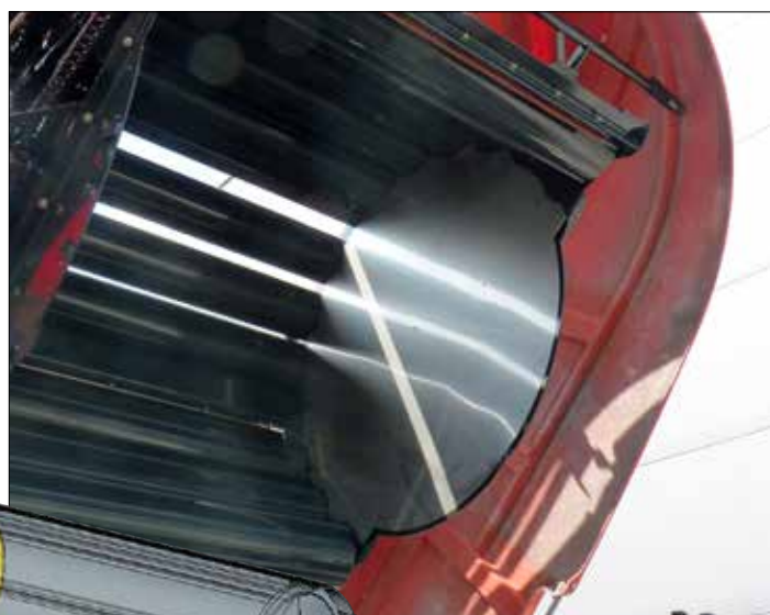
Chapas de aço inoxidável de baixa fricção
