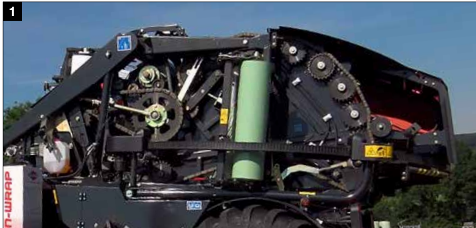
Transmissão robusta com correntes IWIS de alta qualidade
