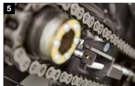
Pincéis de óleo resistentes e largos asseguram uma perfeita lubrificação das correntes.
