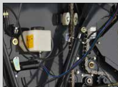
Sistema automático de lubrificação de correntes
