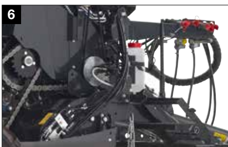
Sistema de lubrificação contínua de corrente BEKA-MAX
