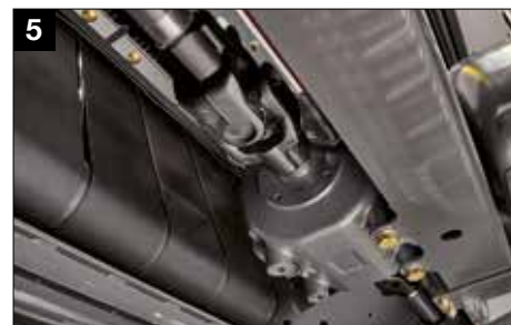
Junções de cardã e cruzetas reforçadas nos eixos de acionamento
