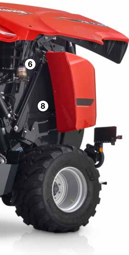
Transmissão robusta com correntes resistentes ao desgaste e de bitola grande
