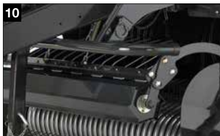
Resistente rolo de cultura com protetor de vento (Ø 217 mm)
