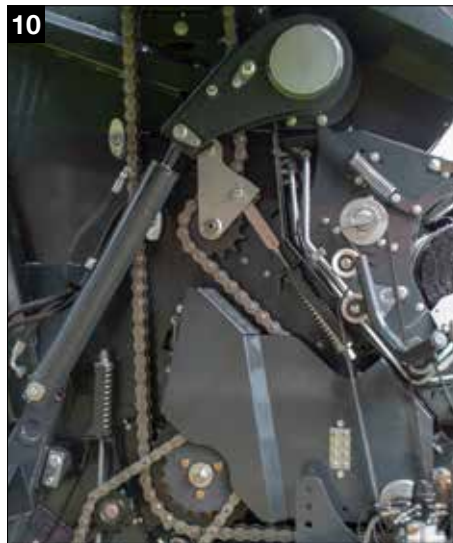
Transmissão robusta com correntes resistentes ao desgaste e de bitola grande
