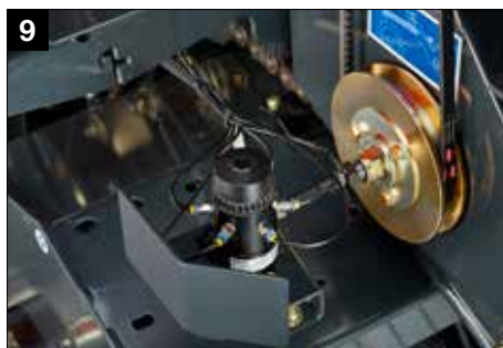
Sistema de lubrificação contínua de corrente BEKA-MAX
