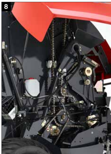
Acionamento robusto com correntes de alta qualidade IWIS + linha propulsora de 1 1/4" 20BH com pinos de cromo endurecido
