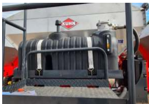
Reservatório de óleo
